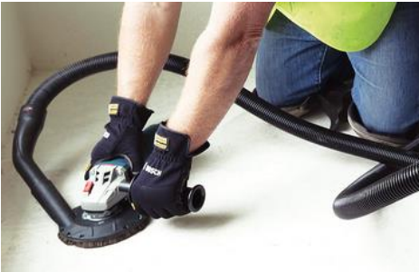
Machine équipée d'un système d'aspiration
