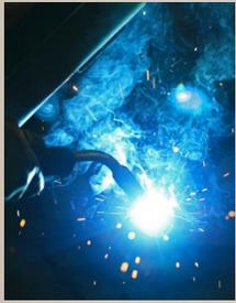
Toutes les fumées émises quel que soit le mode de soudage utilisé exposent à des gaz et à des vapeurs
